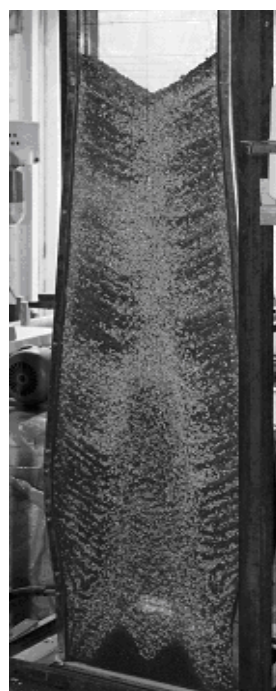
Рис. 2 – Распределение шихтовых материалов по диаметру доменной печи при загрузке обратных подач
