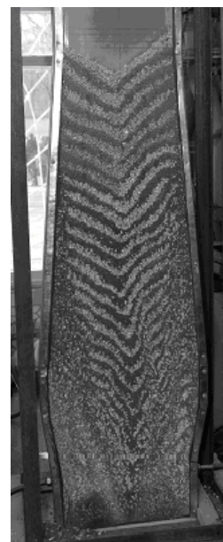
Рис. 4 – Распределение шихтовых материалов по диаметру доменной печи при загрузке подач типа АААА↓ КККК↓ с изменением режима опускания нижнего конуса
