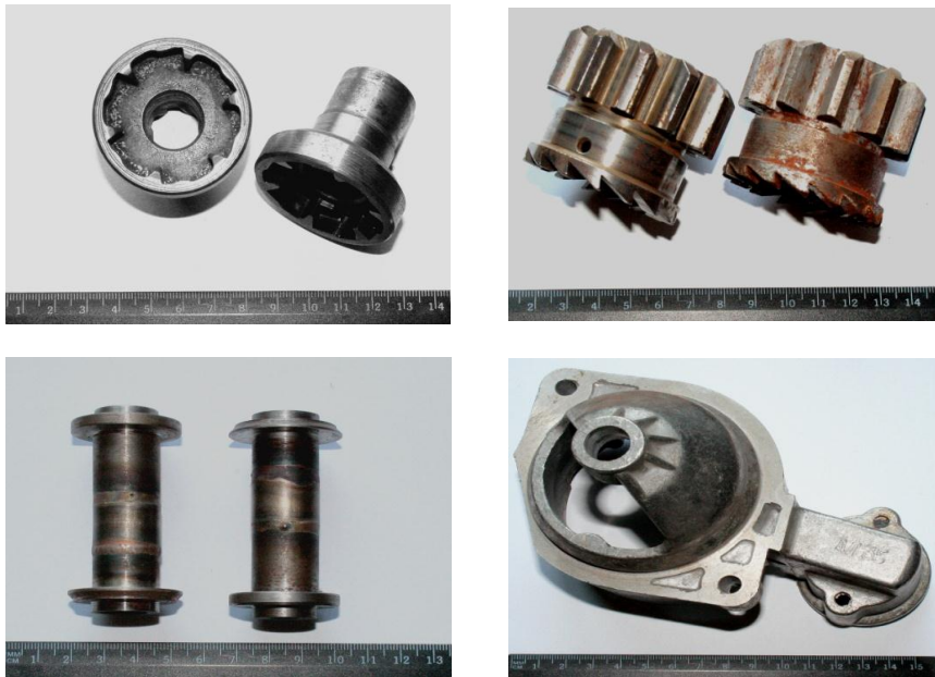
Рисунок 3 – Представители номенклатуры деталей общемашиностроительного применения, подлежащих вибрационной отделочно-зачистной обработке
