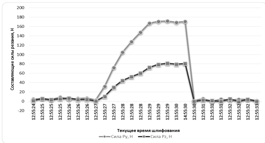
Рисунок б – Складові сили шліфування P_z і P_y як функції часу для експерименту №1 (згідно з табл. 1)
