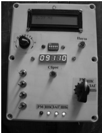
Рисунок 3 – Прибор для измерения частот вращения и врезной подачи
