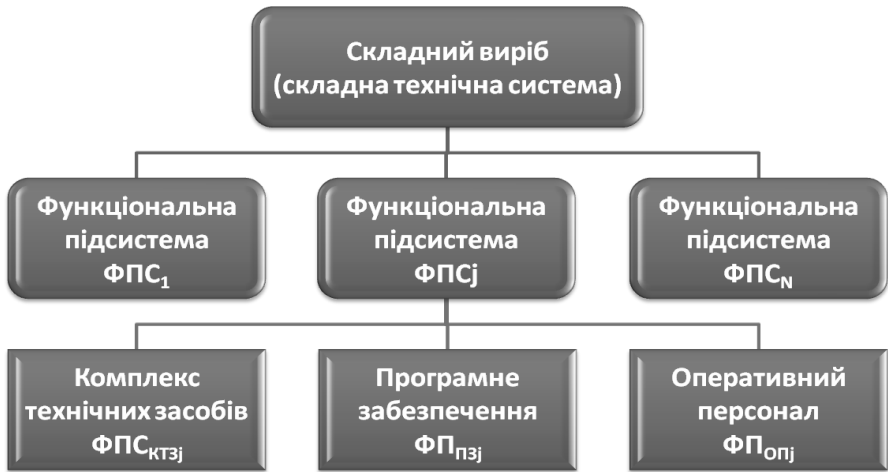
Рисунок 1 – Багатоелементна та багатофункціональна структура складних виробів
