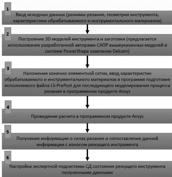
Рисунок 3 – Алгоритм методики предварительной настройки СД состояния режущего инструмента
