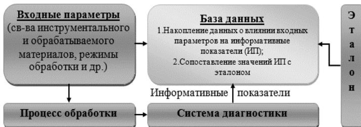
Рисунок 2 – Схема создания базы данных в системе диагностики [1]
