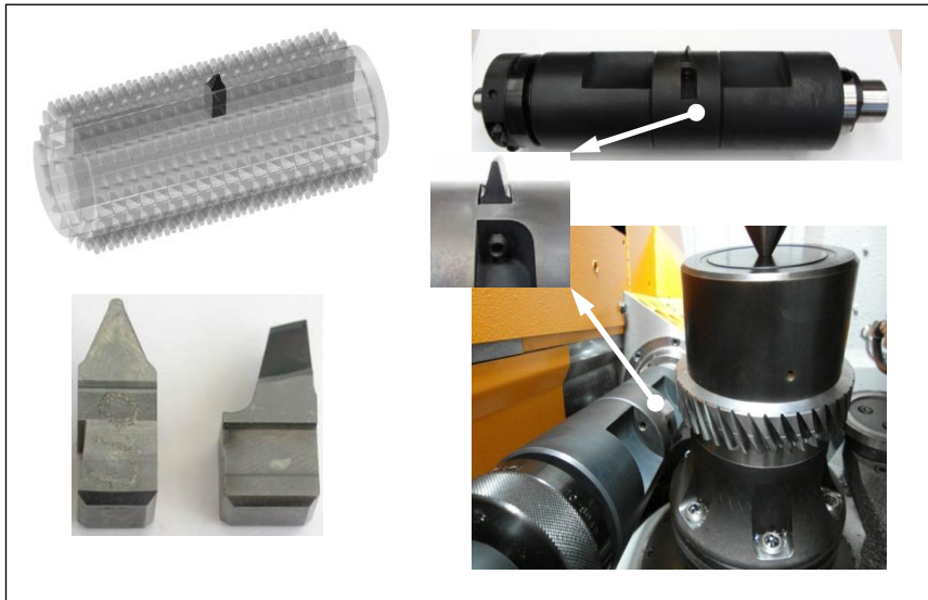
Рисунок 4 – Конструкция однозубой червячной фрезы
