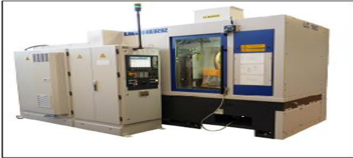
Рисунок 2 – Станок зубофрезерный модели LIEBHERR LC 180
