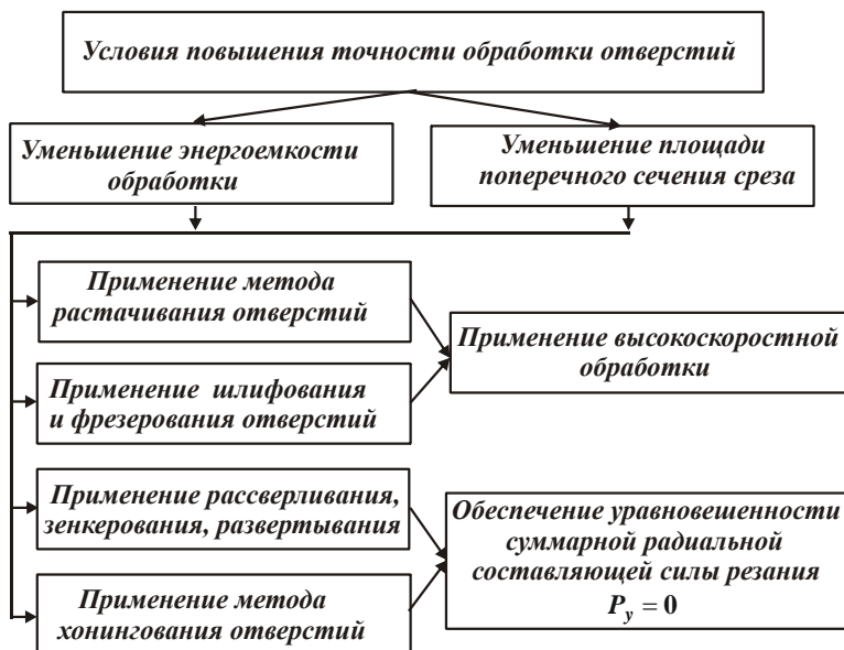
Рисунок 3 – Структурная схема условий повышения точности обработки отверстий с неравномерно снимаемым припуском
