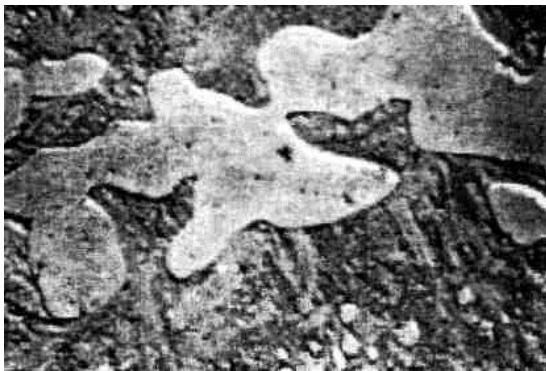
Рисунок 3 – Карбіди типу Me_7C_3 , \times 10000 , відтінення Ge, 30
