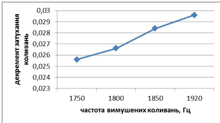
Рисунок 3 – Залежність декременту затування коливань від частоти
