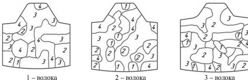
Рисунок 7 – Ізолнії (ізокслери) твердості HV, інтенсивності напружень \sigma_n та інтенсивності деформації e_u
