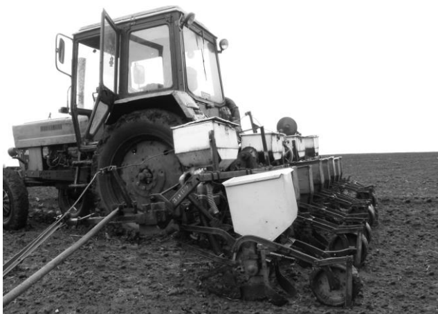
Рисунок 2 – Загальний вигляд дослідного зразка секції пневмомеханічної сівалки
