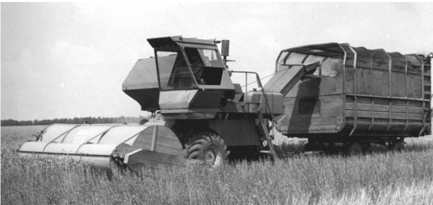
Рисунок 7 - МПУ-4 на базе зерноуборочного комбайна СК-5
