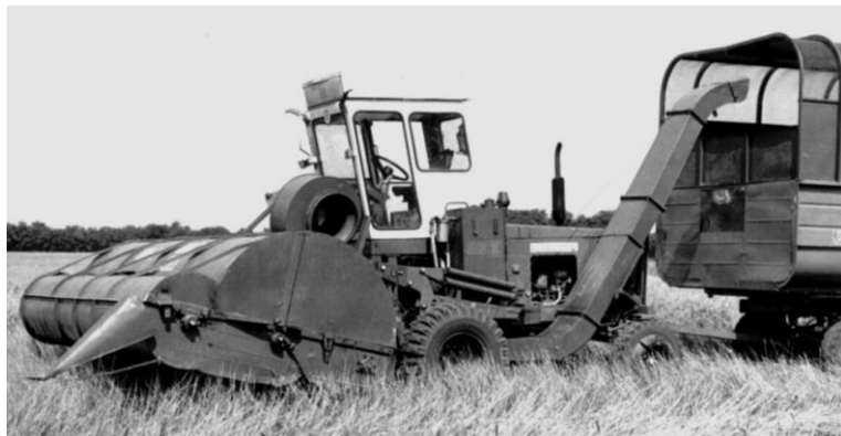
Рисунок 2 - МПУ-5 на базе энергосредства КПС-5Г
