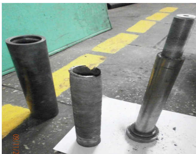
Рис. 2. Картриджі розмірами \varnothing 40 \times 220 , виготовлені радіально-ізостатичним методом та спечені за рахунок СВС-реакції
