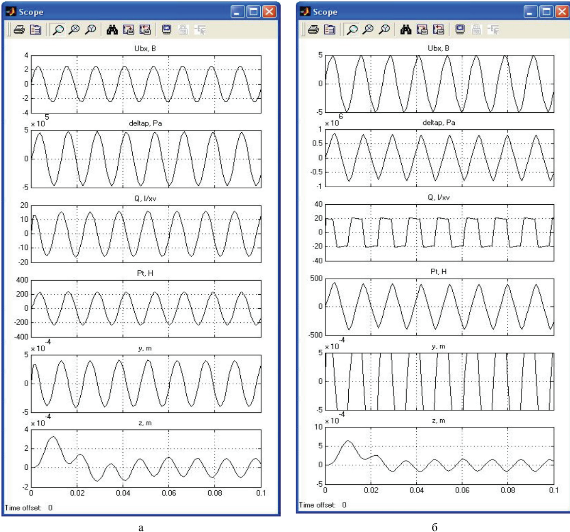
Рис. 7. Перехідні процеси змінних стану системи в середовищі MATLAB Simulink при відпрацюванні гармонічного регулярного сигналу з частотою 500 \text{ c}^{-1} : а — A(u_{\text{BX}}) = 2,5 \text{ B} ; б — A(u_{\text{BX}}) = 5 \text{ B}
