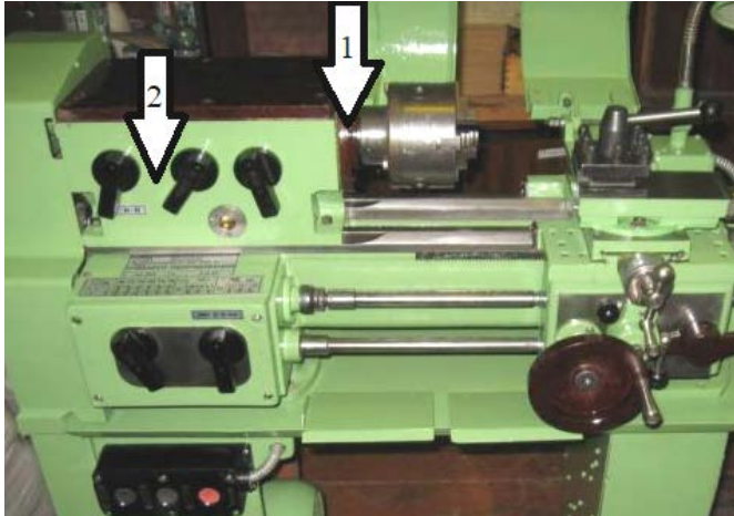
Рис. 1. Контрольні точки для вимірювання температури нагріву підшипників шпиндельного вузла верстата ТВ4
