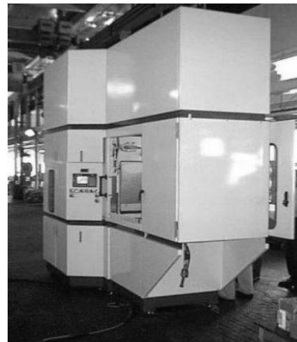
Рис. 3. Модель TF-522 для турбоабразивной обработки дисков турбин диаметром до 500 мм корпорации «Turbo-Finish» [62]
