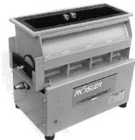
Рис. 4. Вибрационный станок с U-образной рабочей камерой фирмы Rösler [10]
