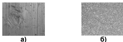
Рис. 12. Поверхность алюминиевых образцов плоской формы: а) до вибрационной обработки; б) после вибрационной обработки
