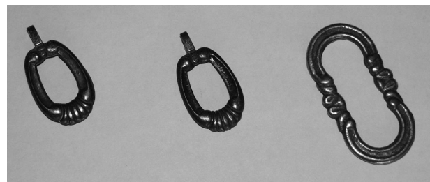
Рис. 11. Детали типа «ручка»: а - до вибрационной обработки; б - после вибрационной обработки
