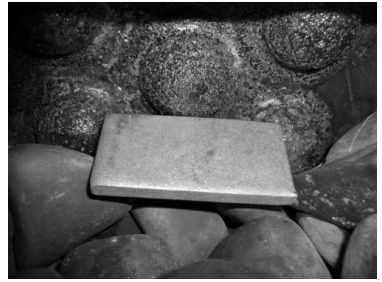
Рис. 10. Плоский образец, застрявший между выступами футеровки
