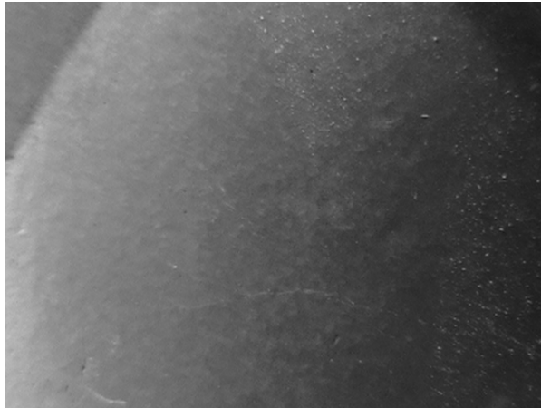
Рис. 8. Оксидное покрытие, модифицированное танином, полученное вибрационным способом после 685 часов коррозионных испытаний в 3%-ном растворе хлорида натрия
