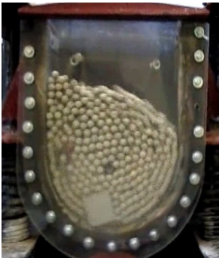
Рис. 3. Наличие в контейнере зоны вторичной циркуляции
