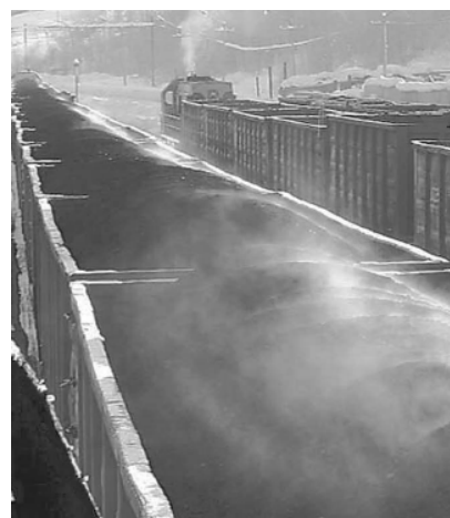
Рис. 1 Уголь, транспортируемый в полувагонах, начинает смерзаться превращаясь в цельный агрегат
