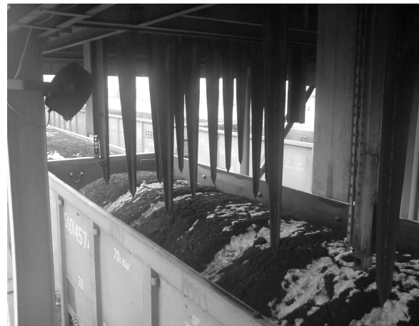
Рис. 3 Вид на рыхлящие штыри перед внедрением в смерзшийся угольный агрегат
