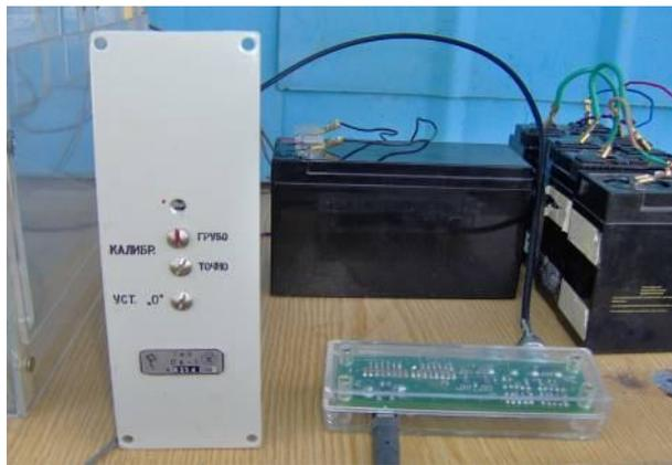
Рис. 5. Приборы для обработки амплитудно-модулированного сигнала: усилитель ПА-1 (справа), USB-осциллограф "IRIS" (слева)
