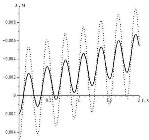
Рис. 5. Зависимость перемещения  $x$  от времени  $t$  при убывании массы
