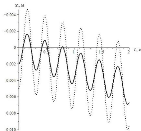
Рис. 3. Зависимость перемещения  $x$  от времени  $t$  при возрастании массы
