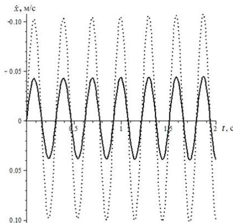
Рис. 4. Зависимость скорости  $\dot{x}$  от времени  $t$  при убывании массы
