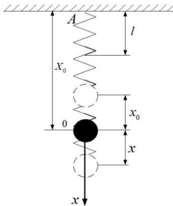
Рис. 1. Расчётная схема вертикальных колебаний осциллятора
