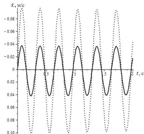
Рис. 2. Зависимость скорости  $\dot{x}$  от времени  $t$  при возрастании массы
