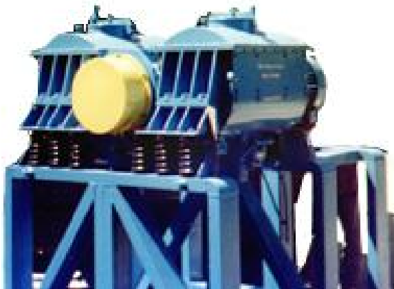
Рис. 2. Вібраційні млини дискретної дії
