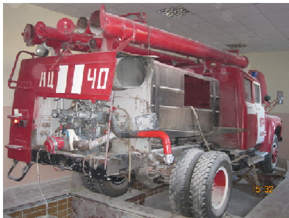
Рис. 1. Діючий макет спеціалізованого автомобіля в лабораторії кафедри пожежної та аварійно-рятувальної техніки НУЦЗУ із встановленим пожежним насосом ПН-40УВ
