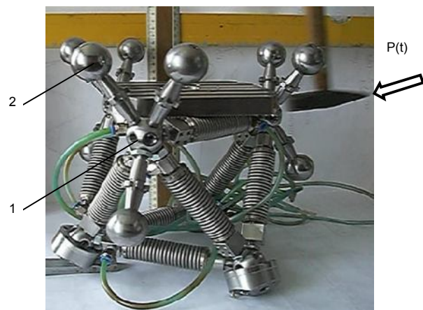
Рис. 6. Експериментальна установка для визначення динамічних характеристик вібраційного обладнання
