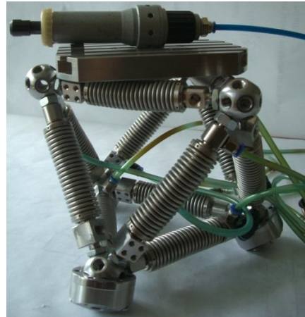
Рис. 1. Вібраційне технологічне обладнання на основі просторової пружно-деформованої системи приводів із встановленим на ній пневмошпинделем
