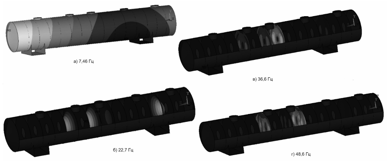
Рис. 5. Форми коливань конструкції авторська розробка
