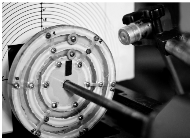
Рис. 6. Схема встановлення АБП 1 – вал, 2 – АБП, 3 – кришка, 4 – дисбаланс, 5 – підшипники
