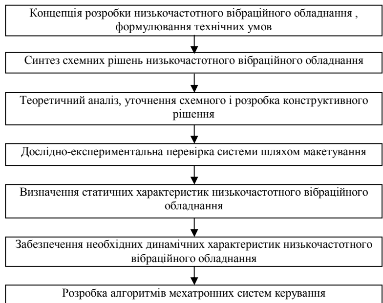
Рис. 1. Основні етапи розробки низькочастотного вібраційного обладнання та їх взаємний зв'язок
