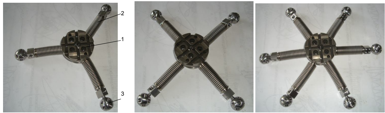
Рис. 3. Низькочастотні вібраційні механізми з різним числом приводів
