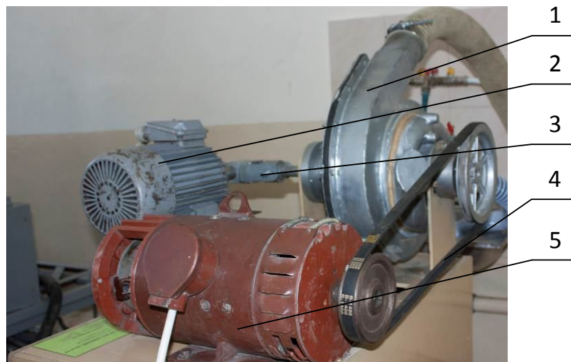
Рис. 6. Лабораторна установка пульсаційного гомогенізатора з вібруючим ротором: 1 – гомогенізуючий вузол; 2 – електродвигун приводу вібрації ротора; 3 – кривошипний механізм; 4 – клинопасова передача; 5 – електродвигун обертання ротора
