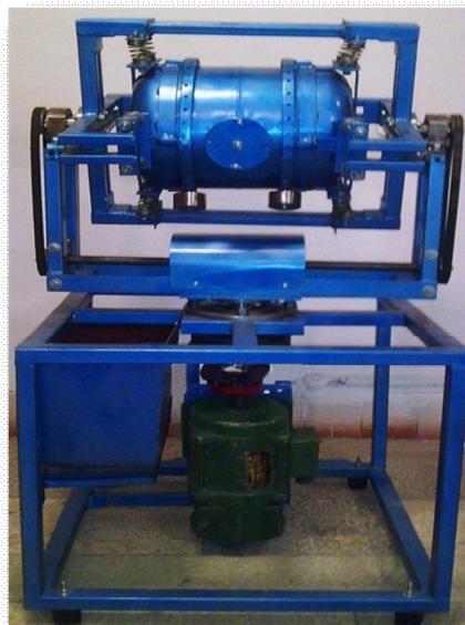
Рис. 5. Вибросмеситель с несколькими центробежными движениями
