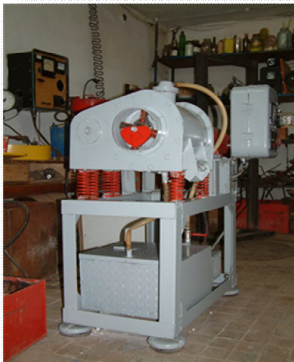
Рис. 4. Вибросмеситель с центральным и периферийным источниками механической энергии
