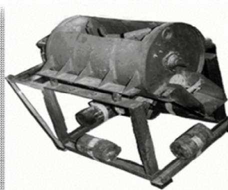
Вибросмеситель с обгонными муфтами
