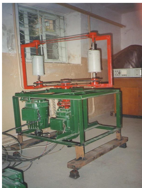
Рис. 8. Машина с планетарным и плоским угловым движением исполнительных органов
