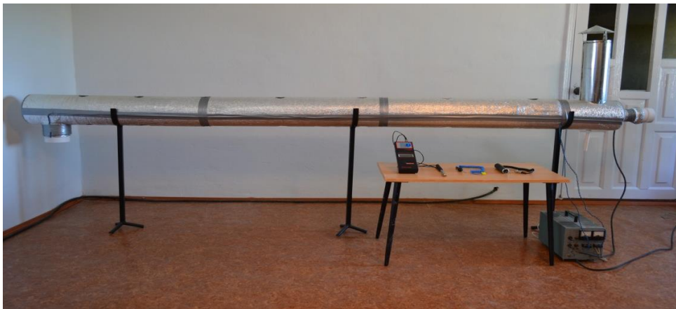
Рис. 3. Загальний вигляд експериментального зразка тритрубного концентричного теплообмінника
