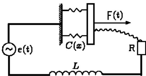
Рис. 4. Конденсаторный микрофон
