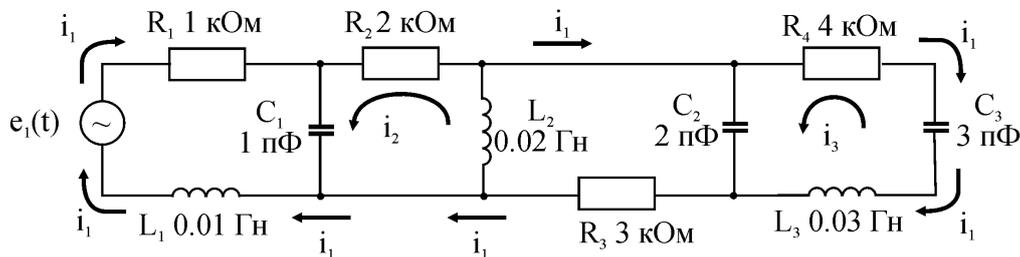
Рис. 1. Схема электрической цепи
