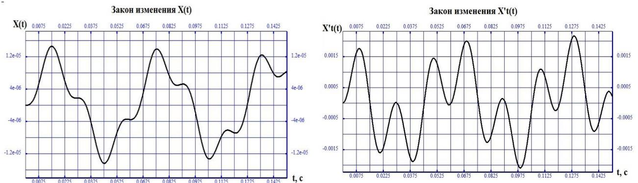
Рис. 5. Перемещение и скорость правой пластины конденсатора
