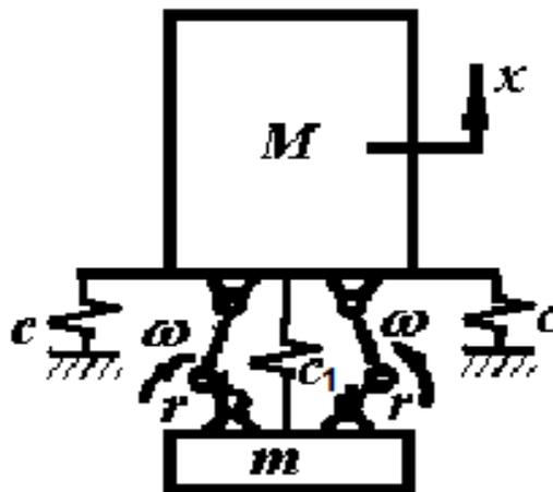
Рис. 3. Инерционный жестко-эксцентриковый привод с упругой связью
