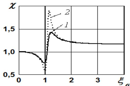
Рис. 2 График зависимости отношения усилий  $P_{01}/P_{02}$  от частоты колебаний
