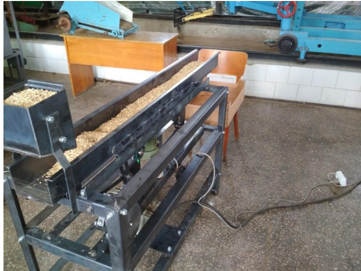
Рис. 4. Загальний вигляд розробленого інерційного конвеєра.
