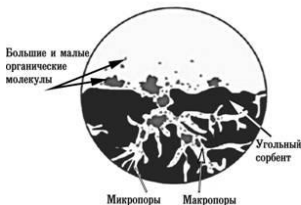
Рис.1. Схема проникновения молекул адсорбируемых веществ в поры.
