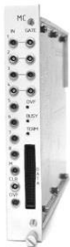
Рис. 4. Загальний вигляд блока лічильників.
