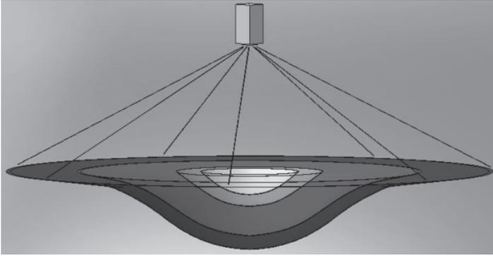
Рис. 2. Графічне зображення ізометричних поверхонь розташування джерела в ґрунті за умови  $P'_o = P_{\max} - P_z$  при  $P_{\max} = 30$  та  $25$  МР/год і  $P_o = 50$  та  $500$  МР/год від комбінації  $P_{\max} = 30$  МР/год та  $P_o = 50$  МР/год (верхня поверхня) до  $P_{\max} = 25$  МР/год та  $P_o = 500$  МР/год (нижня поверхня)
