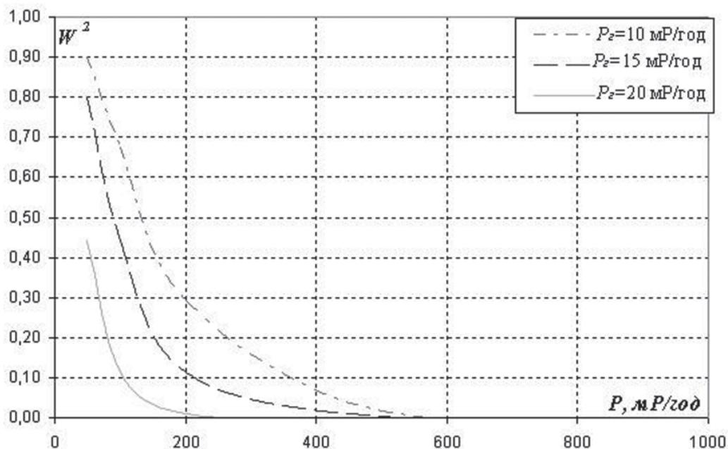
Рис. 7. Ймовірності "пропуску" локальних джерел  $W^2$  після двохетапного сортування на ділянці до вилучення ґрунту та на майданчику ТМ
