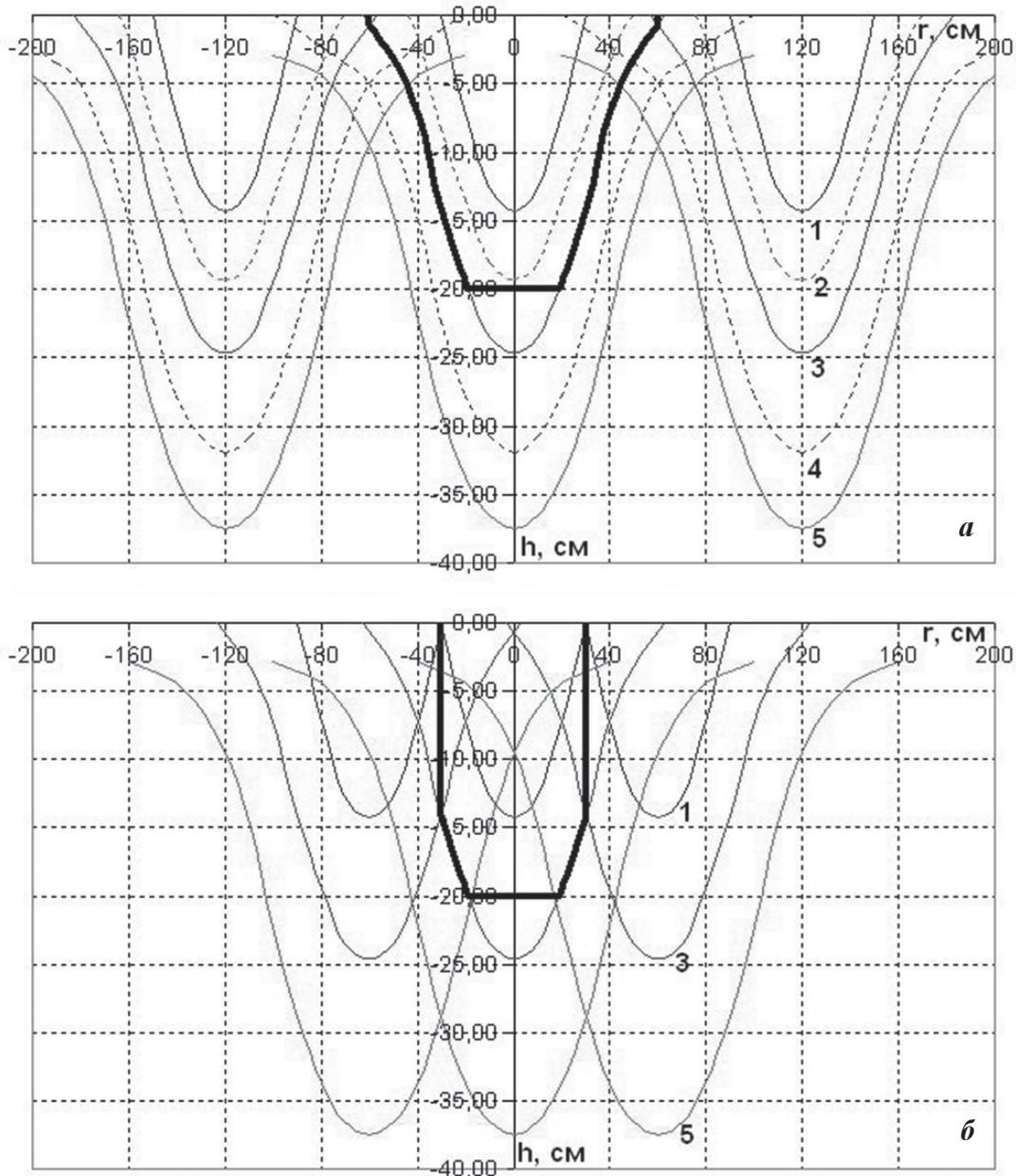
Рис. 4. Границі між контрольованими та неконтрольованими частинами ґрунту в залежності від інтенсивності локального джерела  $P_0$  (1 — 50 мР/год, 2 — 100 мР/год, 3 — 200 мР/год, 4 — 500 мР/год, 5 — 1000 мР/ч) для усереднених значень відстаней між точками вимірювань  $1,2\text{Ч}R$ : а — 1,2 м, б — 0,6 м ( $r$  і  $h$  — крок вимірювань відповідно значень  $R$  і  $H$ )
