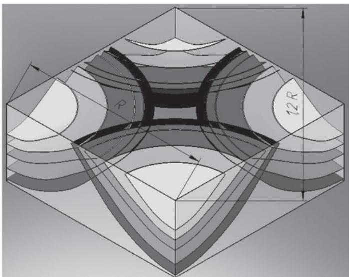
Рис. 3. Ізометричні поверхні, що відповідають умові  $P'_o = P_{\max} - P_z$  при значеннях  $P_o = 50, 100, 200, 500$  та  $1000$  МР/год, від  $P_o = 50$  МР/год (верхні ізометричні поверхні) до  $1000$  МР/год (нижні ізометричні поверхні)
