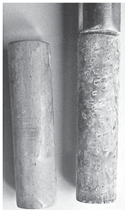
Рис. 9. Внешний вид образцов Al (слева) и Al+X18H10T (справа) после окисления в 0,01 % NaCl на протяжении 150 ч
