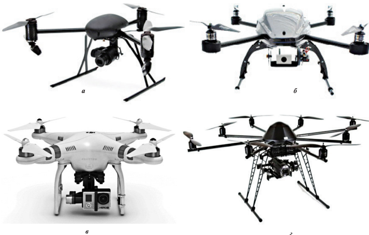
Рис. 3. Сучасні мультикоптери, що виготовляються серійно: а — DFI Draganflyer X6, б — KWA Droidworx CX4, в — DJI Nighthawk P2 T, г — HiSystems Okto 6S
