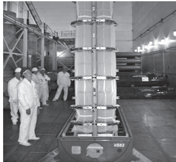
Рис. 2. Сверка номеров ТБСВ и выгрузка ТБСВ из транспортного контейнера
