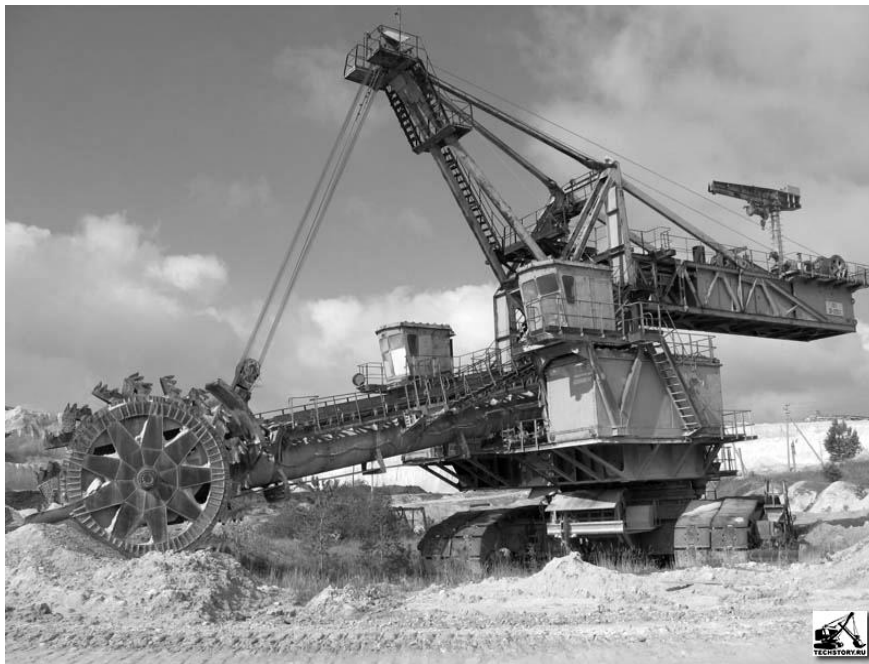
Рисунок 1. Роторный экскаватор с не выдвигной стрелой ЭР-1250-17/1.5А (машиностроительный завод «Донецкгормаш»)
