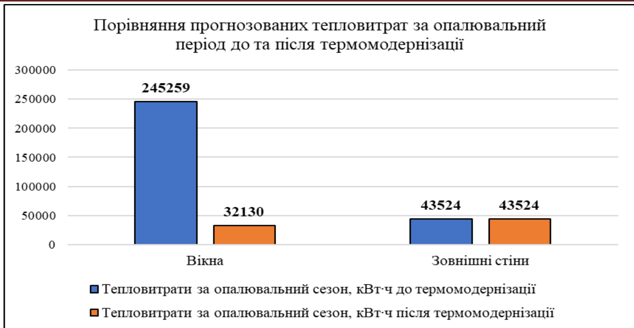
Рисунок 5. Порівняльна діаграма прогнозованих тепловитрат за опалювальний сезон до та після термомодернізації.
