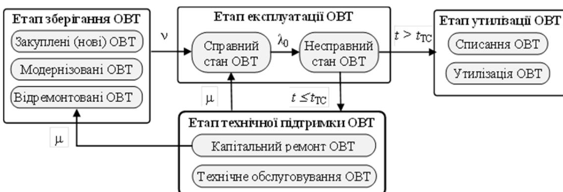
**Рис. 2 – Модель предметної області процесу моніторингу технічного стану парку ОВТ**
