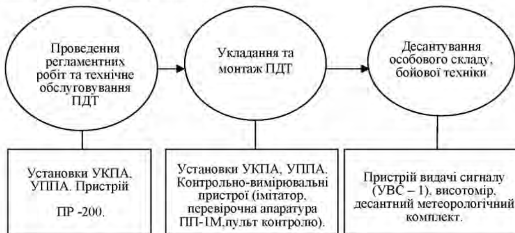
Рис. 1 – Схема метрологічного забезпечення при проведенні підготовки та десантування особового складу, ОВТ та МТЗ
