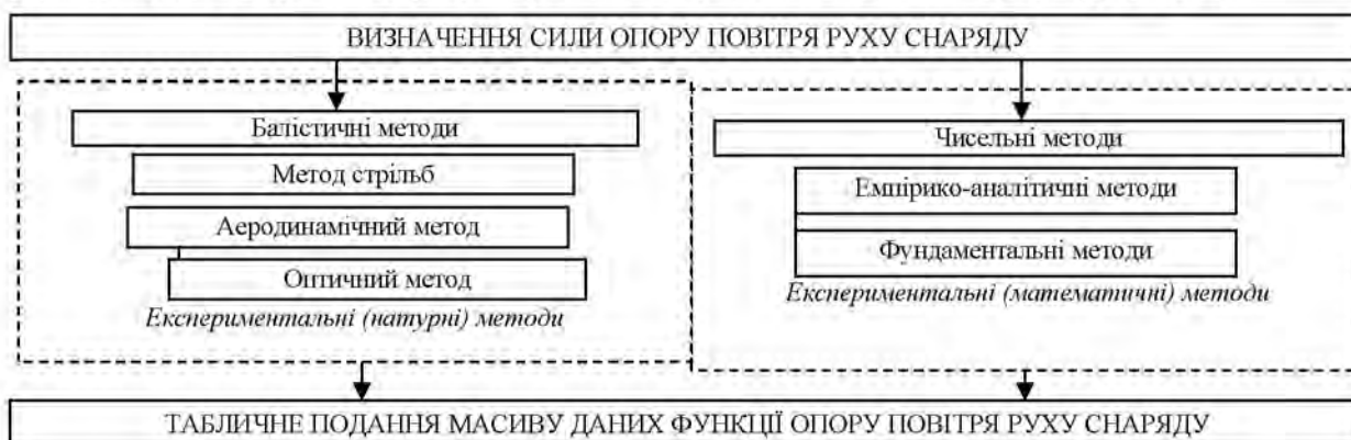
Рис. 1 – Класифікація методів визначення сили опору повітря руху снаряду
