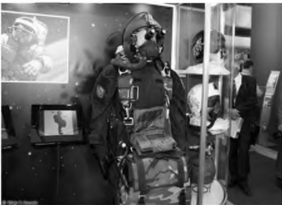
Рис. 4. Комплект кисневого обладнання та спорядження парашутиста ККО-П
