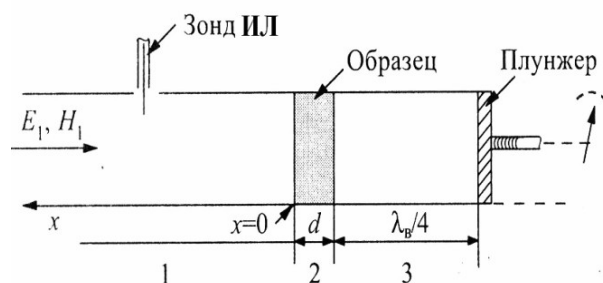
Рисунок 2 – Схема волноводного измерительного тракта
