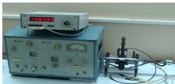
Рисунок 1 – Общий вид измерительного комплекса на базе волноводной измерительной линии (ИЛ) с зондом и передвижным плунжером с микрометрическим винтом
